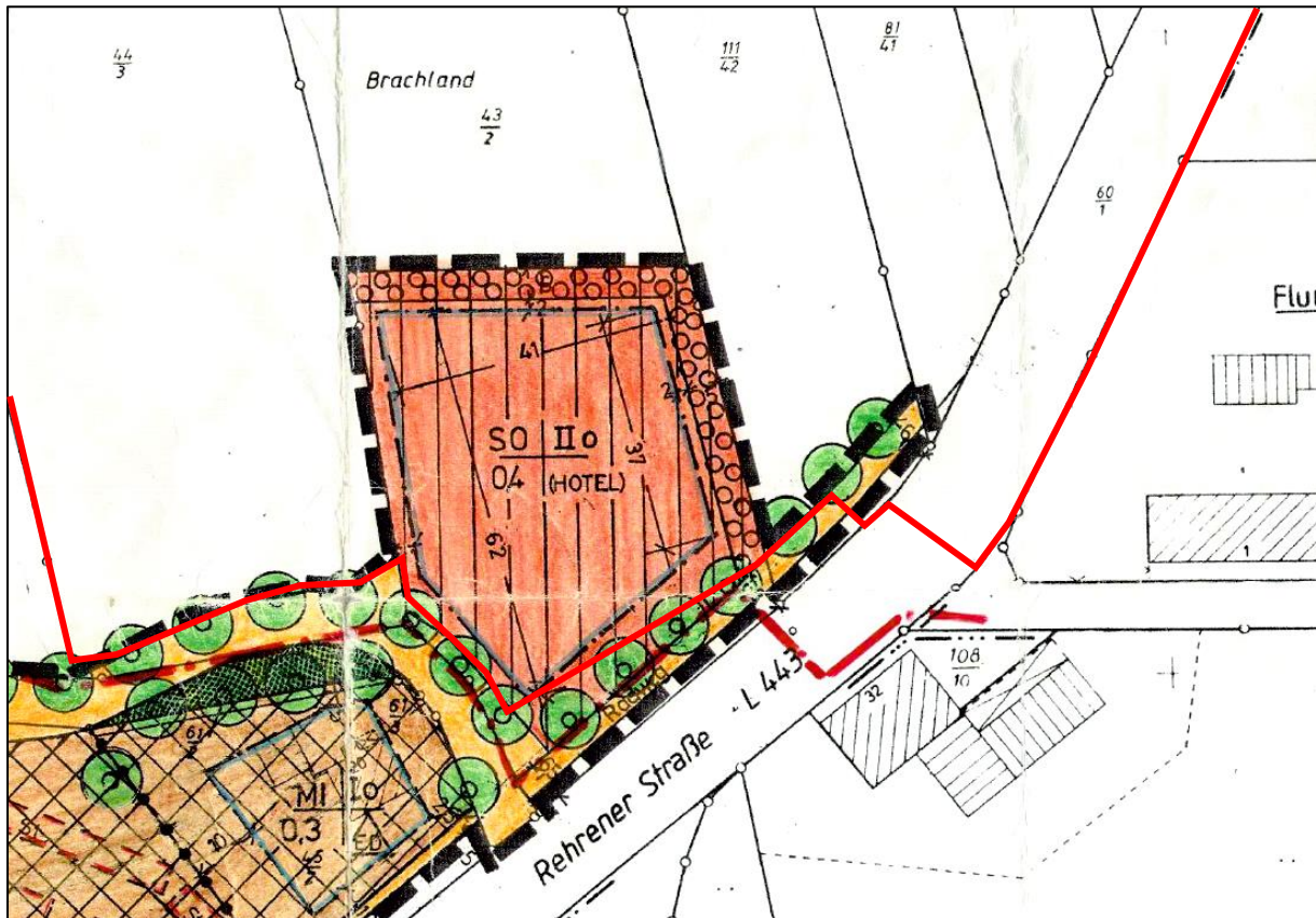
Abb. Auszug aus dem rechtsverbindlichen Bebauungsplan Nr. 9 „Schäferhof“ mit Kennzeichnung des räumlichen Geltungsbereiches des vorhabenbezogenen Bebauungsplanes Nr. 16 (rote Linie)
